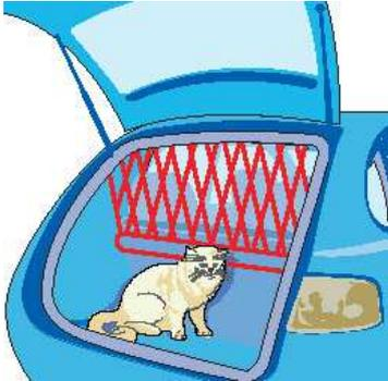
Son unas rejillas, normalmente metálicas, hechas a medida para cada modelo de vehículo. Generalmente, se realizan para retener cualquier tipo de carga, pero actúan perfectamente en el caso de los animales (un animal se asemeja a una carga). Algunas empresas fabrican barreras para distintos modelos de vehículo.
